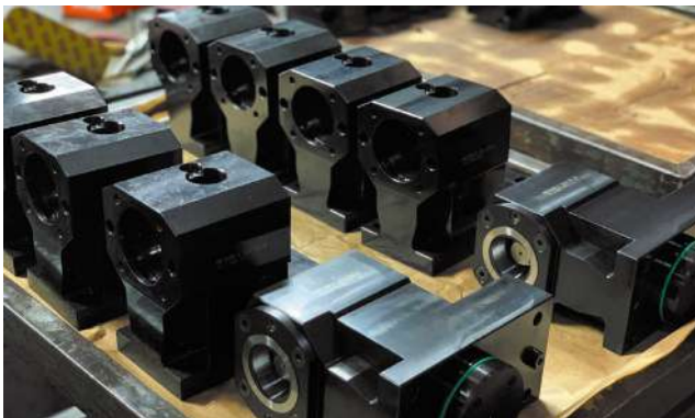
고정 공구 홀더 (Static Toolholders)
