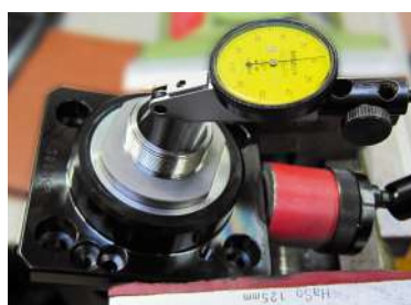
Inspección del Extremo de Salida
